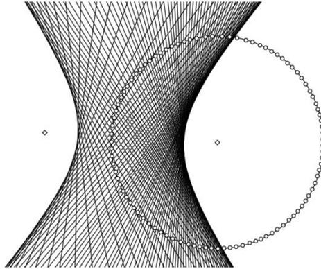
**Figura 17.** Construcción de una hipérbola.
