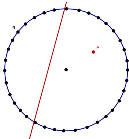
**Figura 13.** Construcción de una elipse.
